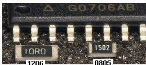
Şəkil. 1206 və 0805 səthi montajlı rezistorlar.
