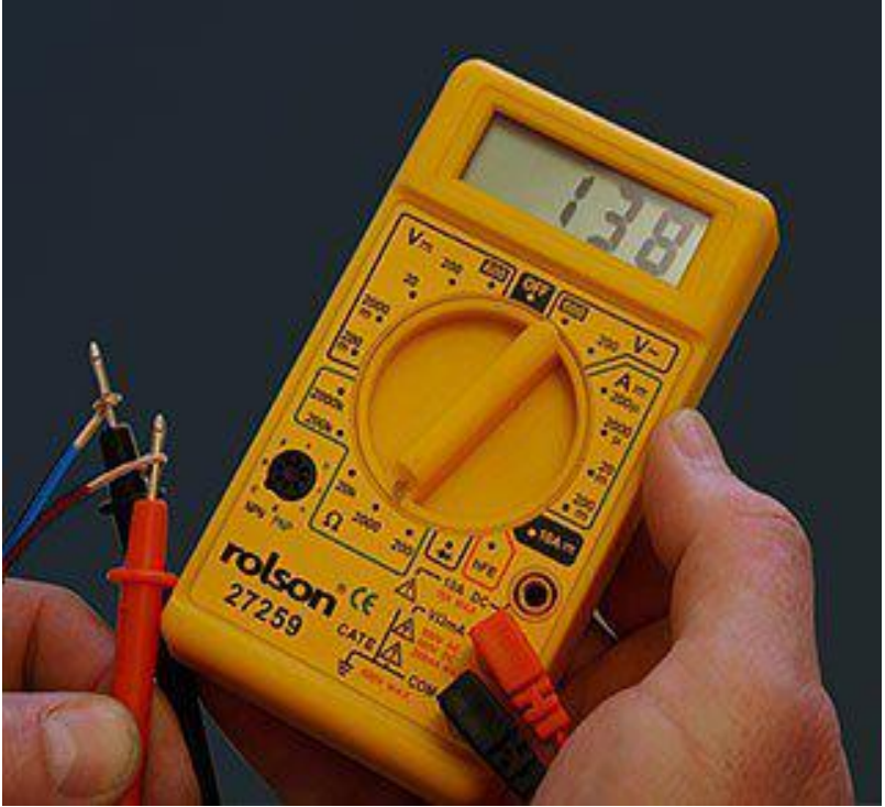
Şəkil. Qızdırıcının müqavimətinin ölçülməsi (qızdırıcının çıxışlarından)
