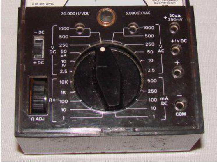
Şəkil. "Om tənzimləməsi" həmçinin "sıfırlama konfigurasiyası" adlanır.
