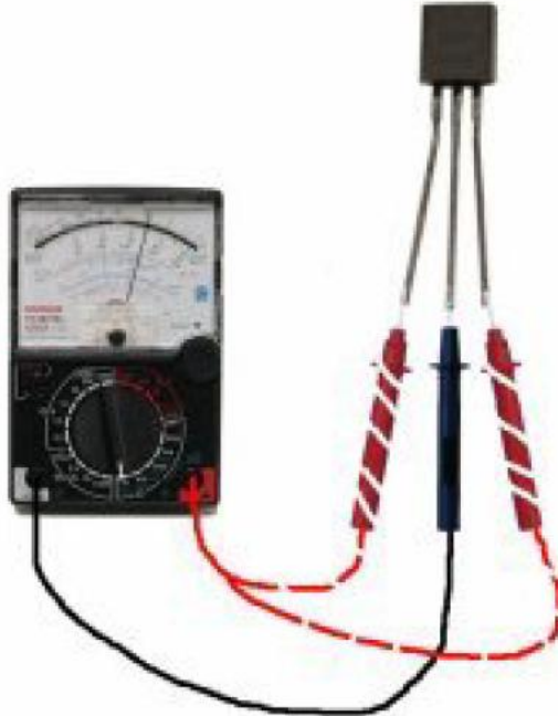
Şəkil. Bu NPN tranzistorudur Toxundurduğumuz qara prob bazadır
