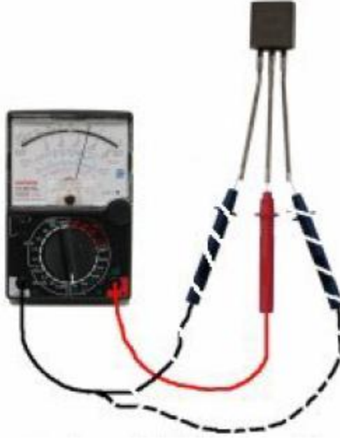
Şəkil. Bu PNP tranzistorudur Toxundurduğumuz qırmızı prob bazadır
