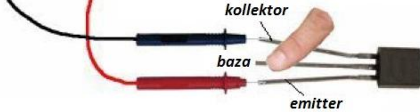
Şəkil. Kollektor, emitter və bazanın təyini.
